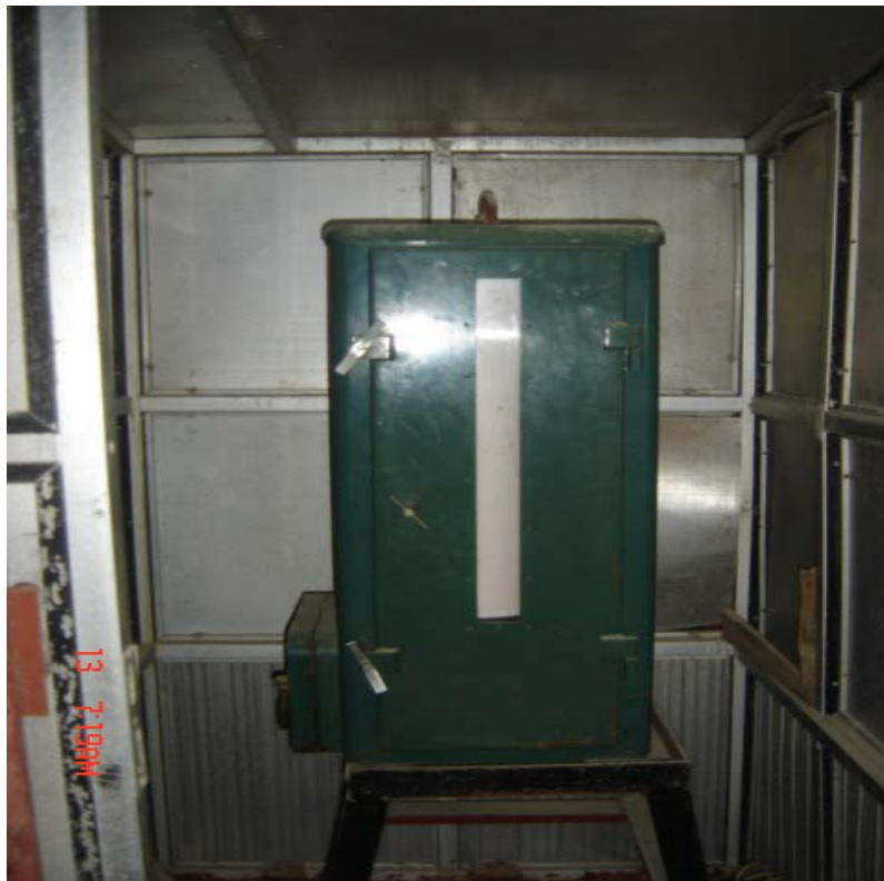
Fig. 3 OTT Tide gauge in the hut.
